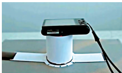
Самодельная установка из бумаги для пересъемки.
